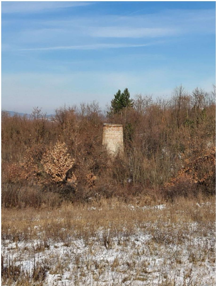
Ovaj ovde čudni dimnjak je zapravo deo železničkog tunela na pruzi Beograd – Niš. Još u vremenu kad su prugama saobraćale parne lokomotive, dimjak je služio da ovede dim iz tunela kojeg proizvodi parna lokomotiva.
